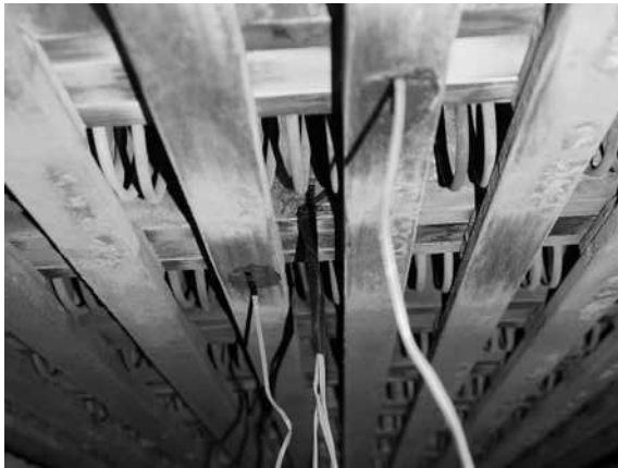
รูปที่ 4-10 การติดตั้งอุปกรณ์ตรวจวัดความเครียดบนผิวเหล็ก (เมื่อวันที่ 6-10 มีนาคม 2558)
