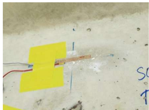
รูปที่ 4-9 การติดตั้งอุปกรณ์ตรวจวัดอุณหภูมิ PT100 (เมื่อวันที่ 6-10 มีนาคม 2558)
