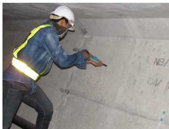
รูปที่ 3-3 การทดสอบกำลังรับแรงอัดของคอนกรีตด้วย Rebound Hammer (ระหว่างวันที่ 1 – 10 มีนาคม 2558)
