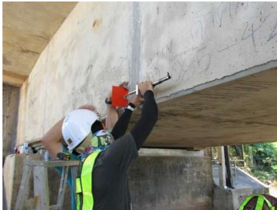
รูปที่ 4-13 การติดตั้งอุปกรณ์ตรวจวัดการเคลื่อนที่ 100 มิลลิเมตร (เมื่อวันที่ 6-10 มีนาคม 2558)
