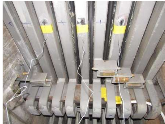
รูปที่ 4-10 การติดตั้งอุปกรณ์ตรวจวัดความเครียดบนผิวเหล็ก (เมื่อวันที่ 6-10 มีนาคม 2558)
