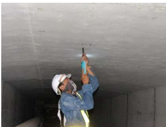
รูปที่ 3-3 การทดสอบกำลังรับแรงอัดของคอนกรีตด้วย Rebound Hammer (ระหว่างวันที่ 1 – 10 มีนาคม 2558)
