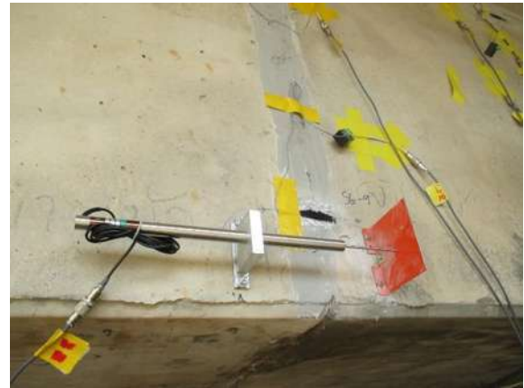
รูปที่ 4-13 การติดตั้งอุปกรณ์ตรวจวัดการเคลื่อนที่ 100 มิลลิเมตร (เมื่อวันที่ 6-10 มีนาคม 2558)
