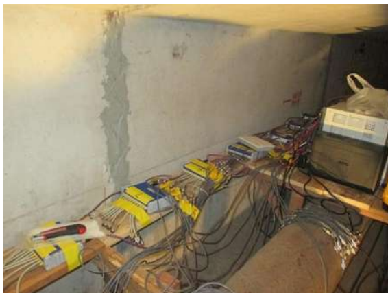
รูปที่ 4-14 การติดตั้งอุปกรณ์รวมสัญญาณ (Data Acquisition) เมื่อวันที่ 11 – 12 มีนาคม 2558
