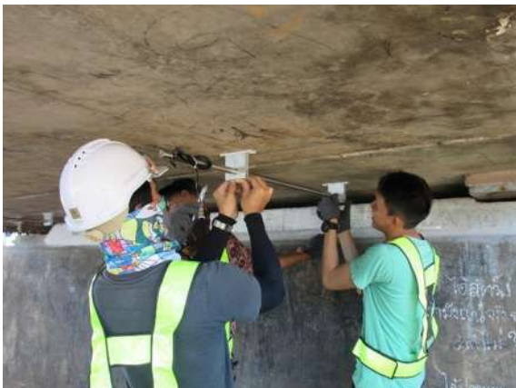
รูปที่ 4-12 การติดตั้งอุปกรณ์ตรวจวัดการเคลื่อนที่ 500 มิลลิเมตร (เมื่อวันที่ 6-10 มีนาคม 2558)
