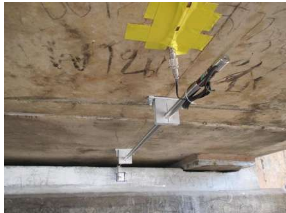
รูปที่ 4-12 การติดตั้งอุปกรณ์ตรวจวัดการเคลื่อนที่ 500 มิลลิเมตร (เมื่อวันที่ 6-10 มีนาคม 2558)
