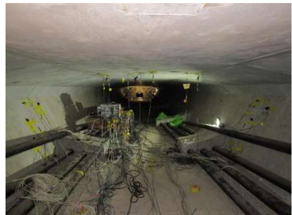
รูปที่ 4-14 การติดตั้งอุปกรณ์รวมสัญญาณ (Data Acquisition) เมื่อวันที่ 11 – 12 มีนาคม 2558
