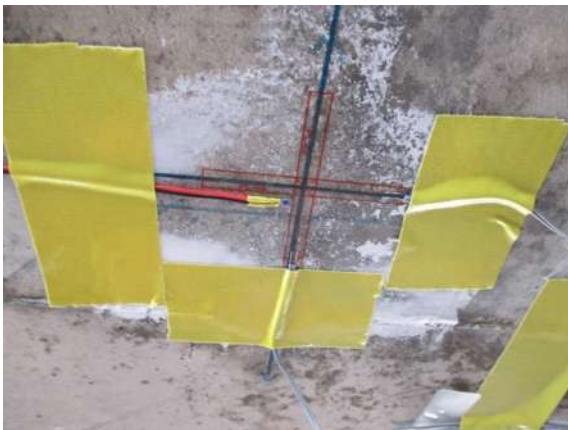
รูปที่ 4-11 การติดตั้งอุปกรณ์ตรวจวัดความเครียดบนผิวคอนกรีต (เมื่อวันที่ 6-10 มีนาคม 2558)
