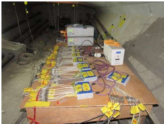
รูปที่ 4-13 การติดตั้งอุปกรณ์ตรวจวัดการเคลื่อนที่ 100 มิลลิเมตร (เมื่อวันที่ 6-10 มีนาคม 2558)
