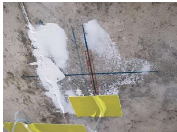
รูปที่ 4-11 การติดตั้งอุปกรณ์ตรวจวัดความเครียดบนผิวคอนกรีต (เมื่อวันที่ 6-10 มีนาคม 2558)
